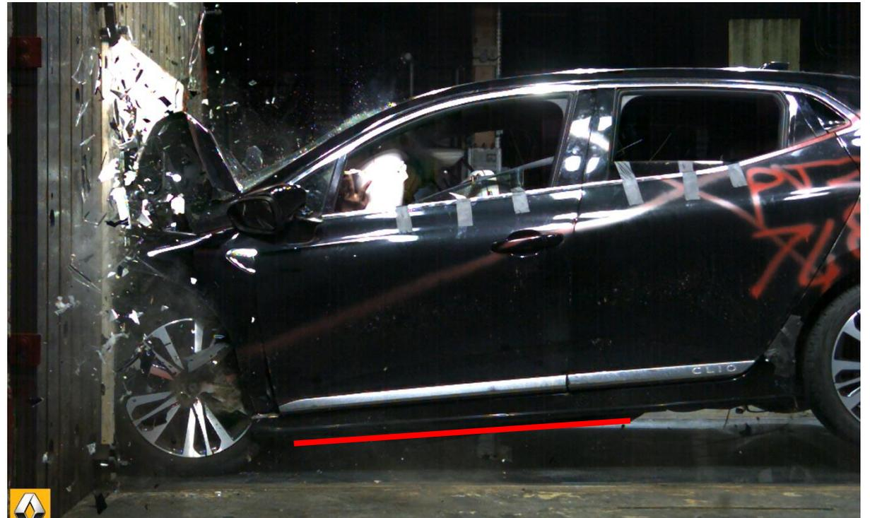
**⚠ Impact de la tête sur le volant dû à la décélération trop importante du véhicule ⚠**
